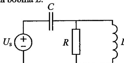
**DATOS:**  $\omega = 1000 \text{ rad/s}$ ;  $R = 25/3 \Omega$ ;  $L = 25/4 \text{ mH}$ ;  $C = 125 \mu\text{F}$ ;  $U_s = 50 \text{ V}$  (valor eficaz).
