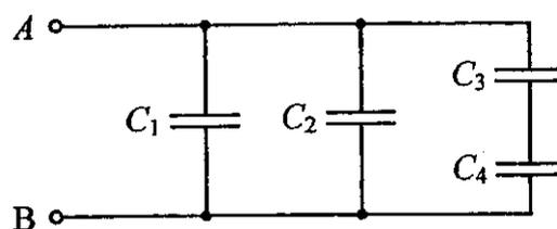
**DATOS:**  $C_1 = 5 \mu\text{F}$ ;  $C_2 = 3 \mu\text{F}$ ;  $C_3 = 20 \mu\text{F}$ ;  $C_4 = 5 \mu\text{F}$
